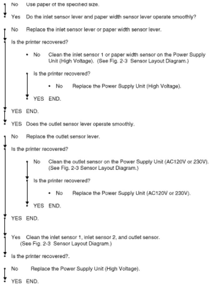
④ Fuser unit error (ERROR 71), (ERROR 72), (ERROR 73)
